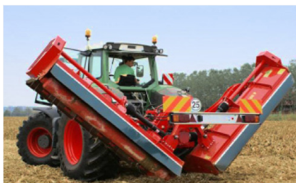
Trasporto stradale a 2,40m con bloccaggio di sicurezza 2.40m road transport width with safety system
